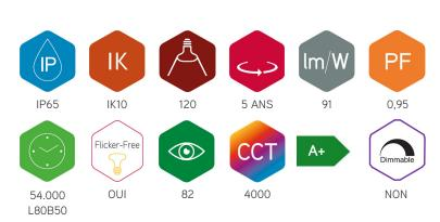
Luminaire LED SOLA pour montage mural ou plafond. Boîtier en polycarbonate IP65 résistant aux chocs IK10. Equipé de bornes de connexion sans vis pour une installation rapide et facile. Avec des entrées de câbles sur le dessus et sur les côtés. Avec capteur hf et unite de secours 3h 3W 250~300lm intégré. Détection jusqu'à 9 mètres en cas de montage mural.
