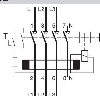
**TEST** et visualisation défaut différentiel: lors de l'action sur le bouton test, l'interrupteur différentiel doit déclencher.
