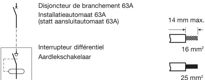
Raccordement électrique en Ph/N ou triphasé sans neutre
