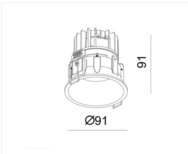
Encastré avec réflecteur positionné en retrait, pour un éclairage efficace mais discret, et avec un éblouissement minimal.
