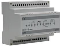
Cette interface modulaire vous permet de raccorder un système de contrôle d'accès au réseau téléphonique. Cet appareil est équipé des fonctions suivantes: connexion en parallèle d'un maximum de 64 interfaces téléphoniques, mémoire d'appel pour 64 numéros d'appel, commande du relais de gâche électrique et du relais d'éclairage, commande d'un maximum de 10 relais bus, temps de commutation programmable, etc.
