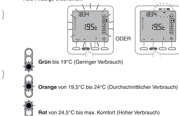
Aktivieren Sie die Funktion Displaybeleuchtung (CF05), um diese Funktion je nach Thermostatsmodell zu nutzen.
