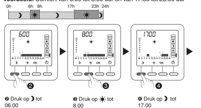
De programmering kan worden gedaan in 1 uur of 1/2 uur
