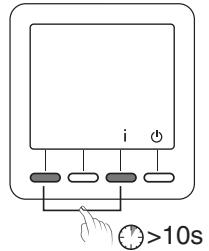
❶ Druk 10 seconden gelijktijdig op de linkertoets en de toets **i** totdat "Init" wordt weergegeven.
