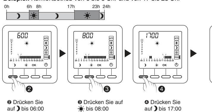
Die Programmierung kann in Stunden- oder 30-Minuten-Schritten ausgeführt werden (Menü Konfiguration CF11).
