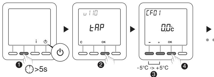
Le thermostat doit être en mode Arrêt.
