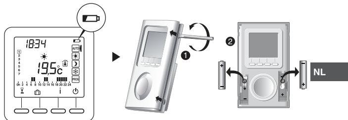
Vanaf het moment dat het symbool op het scherm wordt weergegeven, hebt u ongeveer 3 maanden de tijd om de batterijen te vervangen (zie technische kenmerken).
