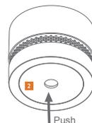
4) Assurez-vous que le détecteur de fumée est activé en appuyant sur le bouton de test pendant 1 seconde. Lorsque le détecteur de fumée donne un signal d'alarme les tests sont effectués avec succès et votre détecteur de fumée est prêt à l'utilisation.
